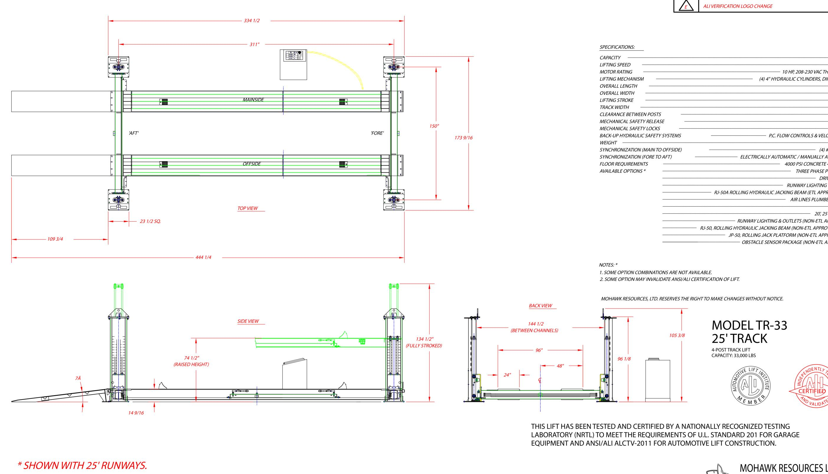
\*\* POWER UNIT LOCATION PER CUSTOMER'S SPECIFICATION. SHOWN ABOVE IN STANDARD LOCATION.
