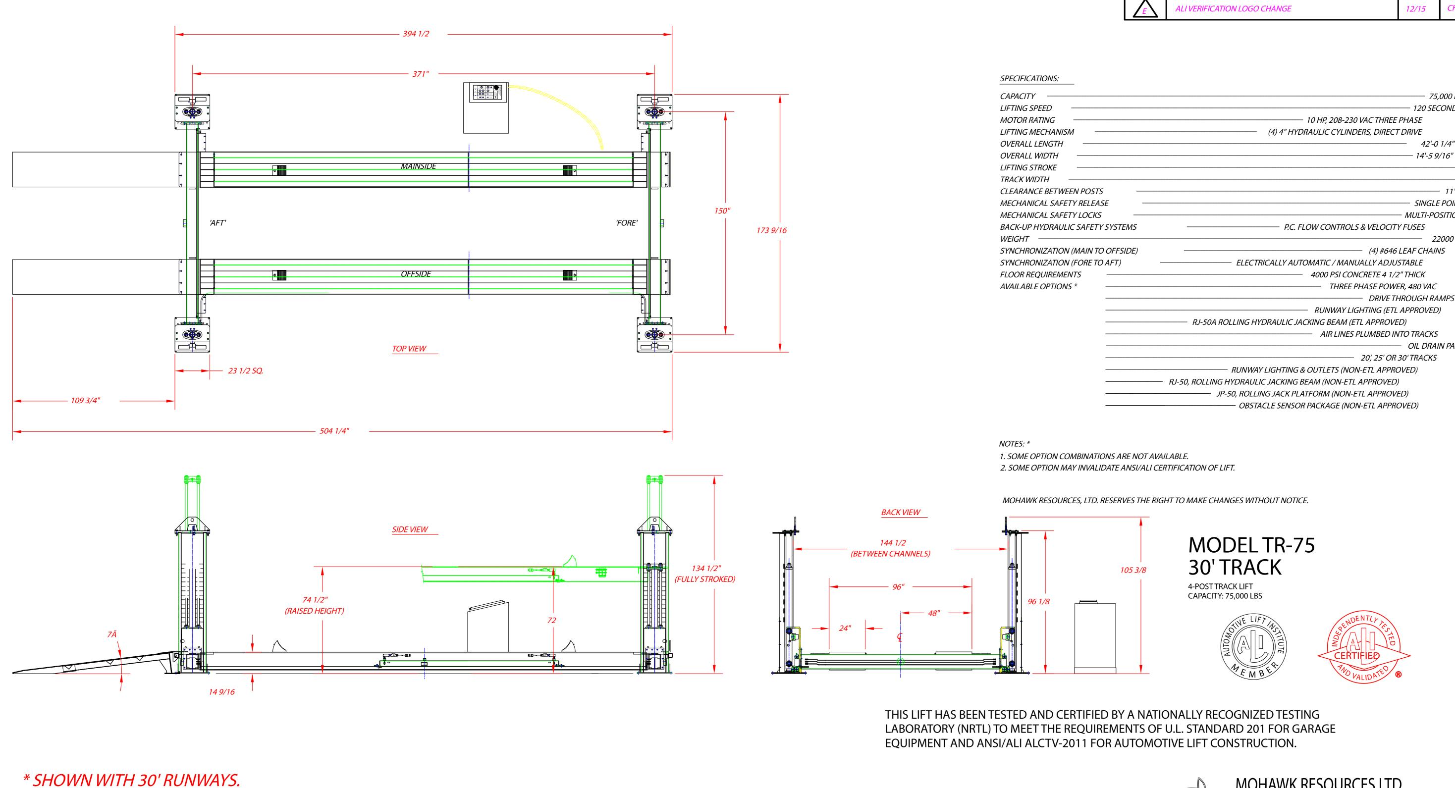
\*\* POWER UNIT LOCATION PER CUSTOMER'S SPECIFICATION. SHOWN ABOVE IN STANDARD LOCATION.
